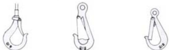
I ganci per apparecchi di sollevamento devono essere provvisti di dispositivi di chiusura dell'imbocco o essere conformati, per particolare profilo della superficie interna o limitazione dell'apertura di imbocco, in modo da impedire lo sganciamento delle funi, delle catene e degli altri organi di presa.
